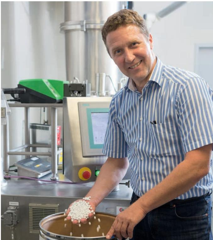
Geschäftsführer Ulf Waag mit Styropor-Kugeln, die mit Keramik beschichtet und gesintert zu sehr festen, leichten Werkstoffen werden (Bild unten). Die hollomet-Metallwerkstoffe können gesägt, gestanzt, gebohrt, gelötet, geschweißt und zerspannt werden (Bild oben).
