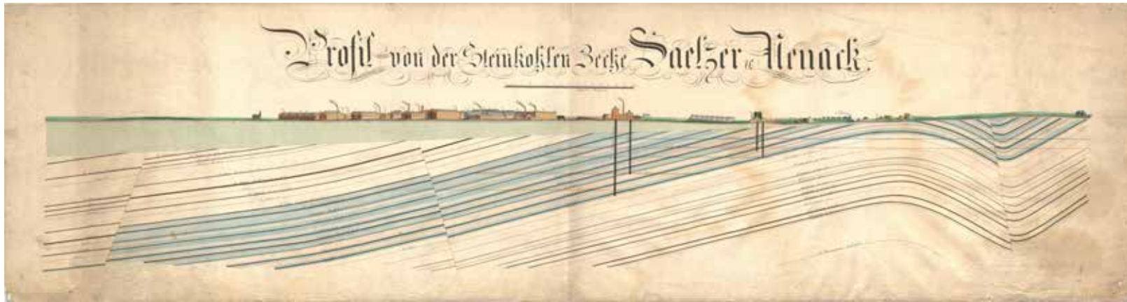
Abb. 3 Profilriss des Steinkohlenbergwerks Saelzer & Neuack in Essen, Zeichnung von Markscheider Ludwig Achepohl, ca. 1866.
