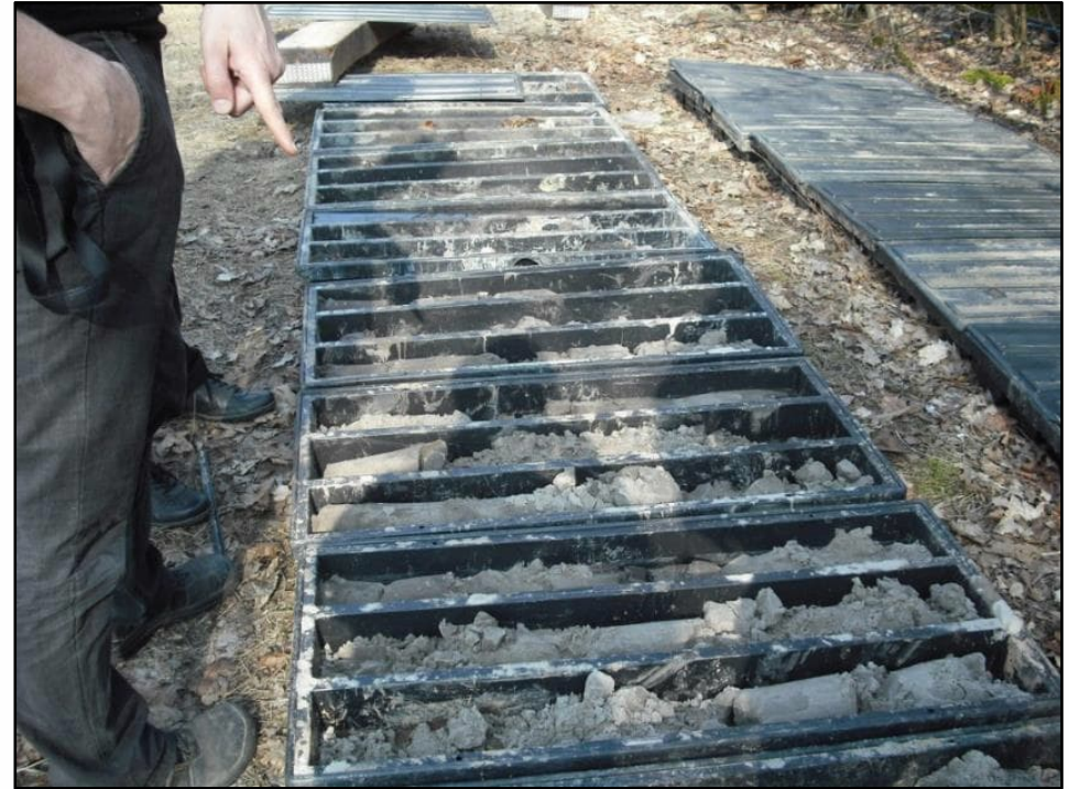
Kernkisten der Bohrung Sanierungsbrunnen
