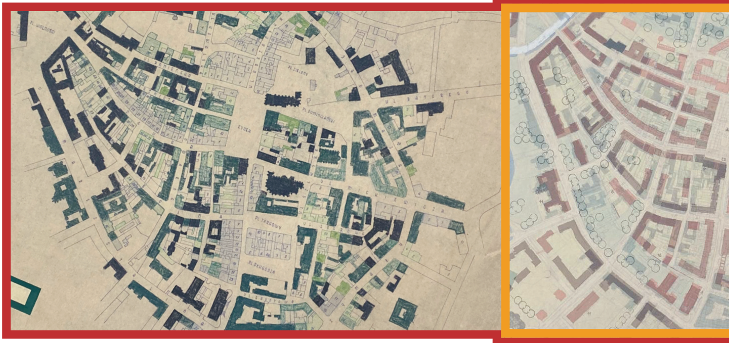
Racibórz (Polen): Überlagerung (Mitte) einer Karte der Kriegsschäden im Stadtzentrum (links) mit dem Wiederaufbauplan (rechts). In der Überlagerung stehen die braunen Markierungen für geplante Bauten, während die schwarzen historische Denkmäler repräsentieren. Die dunkelgrünen Gebäude in den Grünanlagen kennzeichnen Bauten, die den Krieg überstanden haben, aber abgerissen werden sollten.
